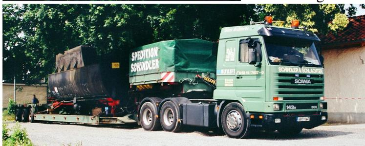
Nach mehreren Anschlagversuchen konnte das Fahrwerk einigermaßen parallel angehoben werden. Auf den Anhänger wurde ein Gleisstück verladen und das Fahrwerk daraufgesetzt. Auf den Schienen wurden Anschläge festgeschweißt.
