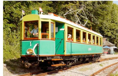
Ganz ähnlich wird der B 11 dann aussehen, nur ohne Führerstand und Antriebstechnik. Dieser Triebwagen wurde von der ÖGLB aus einem baugleichen Beiwagen neu aufgebaut. (Foto: FJ)
