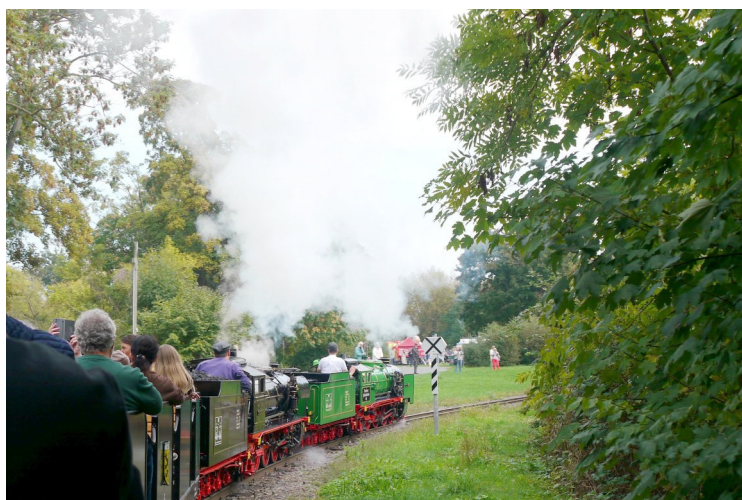
Vorspannbetrieb, an der Kreuztafel der Einfahrt des Bf Auensee
