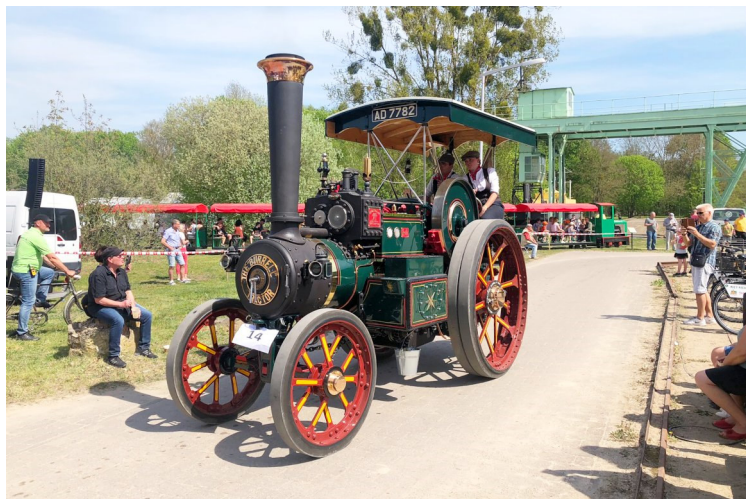
Ursprünglich aus England, angereist aus den Niederlanden: Burrell „Pouss-nouk-nouk“ Dampftraktor mit einer Zweizylinder-Verbund-Dampfmaschine, Baujahr 1919
