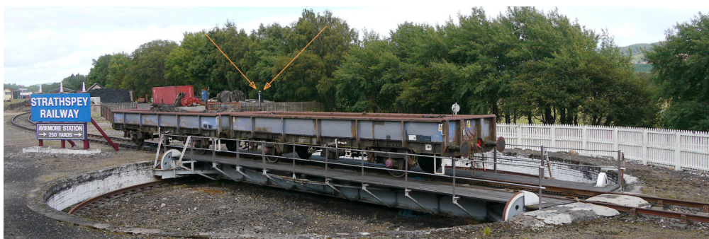
... nämlich die Drehscheibe in Aviemore. Leider war der beschriebene Anschluss für die Vakuum-Bremsleitung der Lok, zur Versorgung des Antriebsmotors, vom fahrenden Zug aus nicht zu entdecken, und wurde sogar auf unserem Foto erst nach Recherche im Internet erkannt (siehe Pfeilspitzen).
