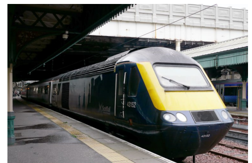
InterCity-Triebkopf (Diesellok) im Bahnhof Waverly unter der Zufahrtsbrücke
